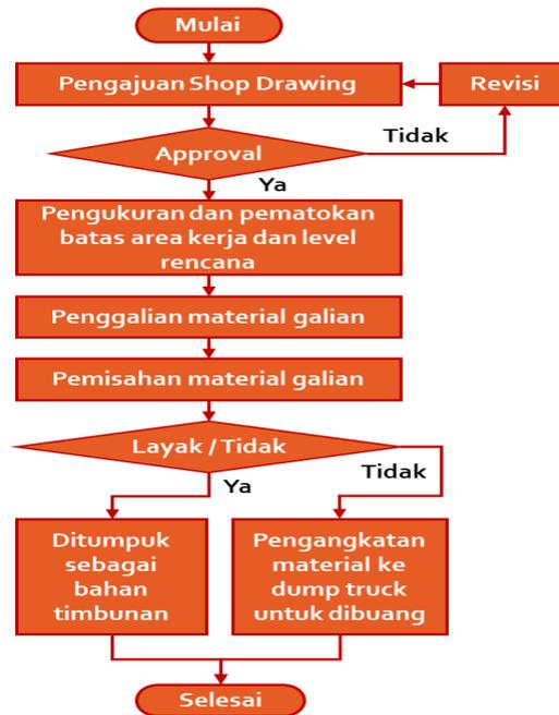
Gambar 1. Diagram Alur Pekerjaan Galian Struktur
