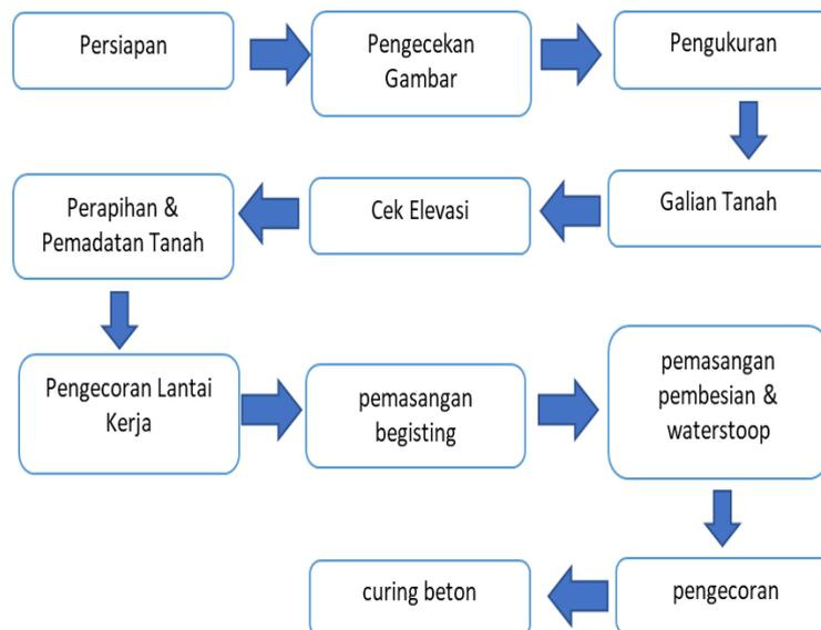
Gambar 3. Diagram Alur Pekerjaan Footing
