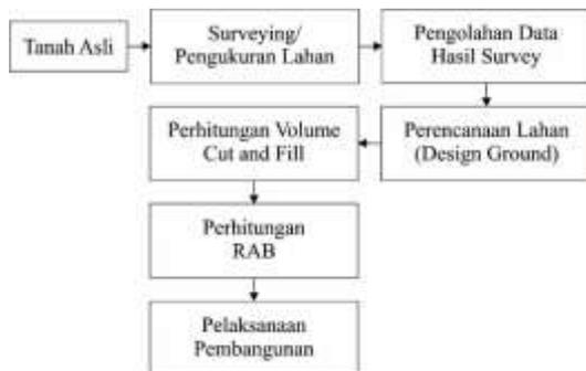
Gambar 3. Diagram Alir Dalam Tahapan Persiapan Lahan Kawasan PT PLIE
