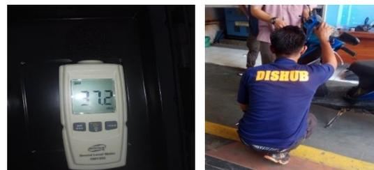
Gambar 3.5 Pengujian Dengan Sound Level Meter
